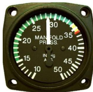
**ALTITUDE CRÍTICA** – É a altitude acima da qual o compressor torna-se incapaz de manter a pressão de admissão, causando então a perda de potência do motor.
