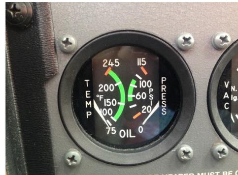
**Termômetro de óleo** - Indica a temperatura do óleo do motor.
