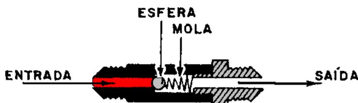
**Válvula de contorno ou “by-pass”:** é uma válvula que abre-se acima de uma determinada pressão, com a finalidade de oferecer um caminho alternativo para o óleo. É muito usada nos filtros de óleo, a fim de permitir o fluxo do lubrificante quando o filtro ficar obstruído (*é melhor permitir que o motor funcione com o óleo não filtrado do que sem nenhum óleo*)
