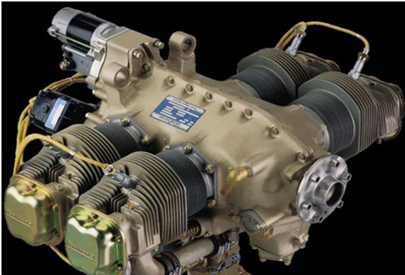
Num motor superalimentado, o ar é aspirado por um compressor que o comprime e envia, sob pressão, para os cilindros, tendo assim uma pressão de admissão maior que a pressão atmosférica, ou seja, 29,92 polegadas, 760 mm proporcionando ao motor funcionar em altitudes elevadas como se estivesse ao nível do mar.
